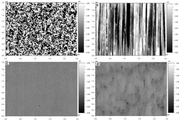
**Figure 9:** Profiles of Types (a) V, (b) VI, (c) VII, and (d) VIII surface textures.
